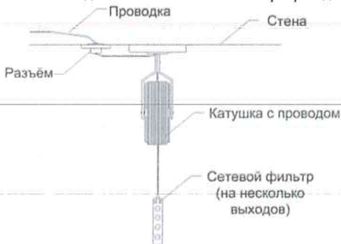
Рисунок 3 - Схема мобильной проводки в «чистом» помещении
